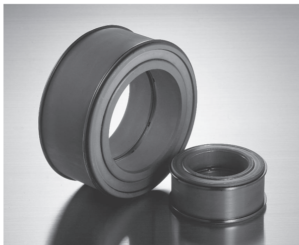
■ Rolamentos de rolos cilíndricos de duas carreiras do tipo complemento total para roldanas de cabos de guindaste (CAT. NO. 201E)
